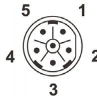
Разъем электропитания для коммутаторов серии TN-4500A
